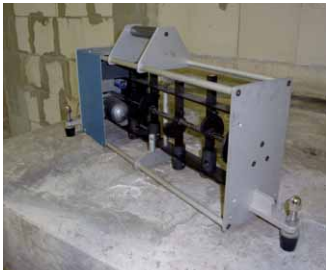
Normhammerwerk nach DIN EN ISO 10140
